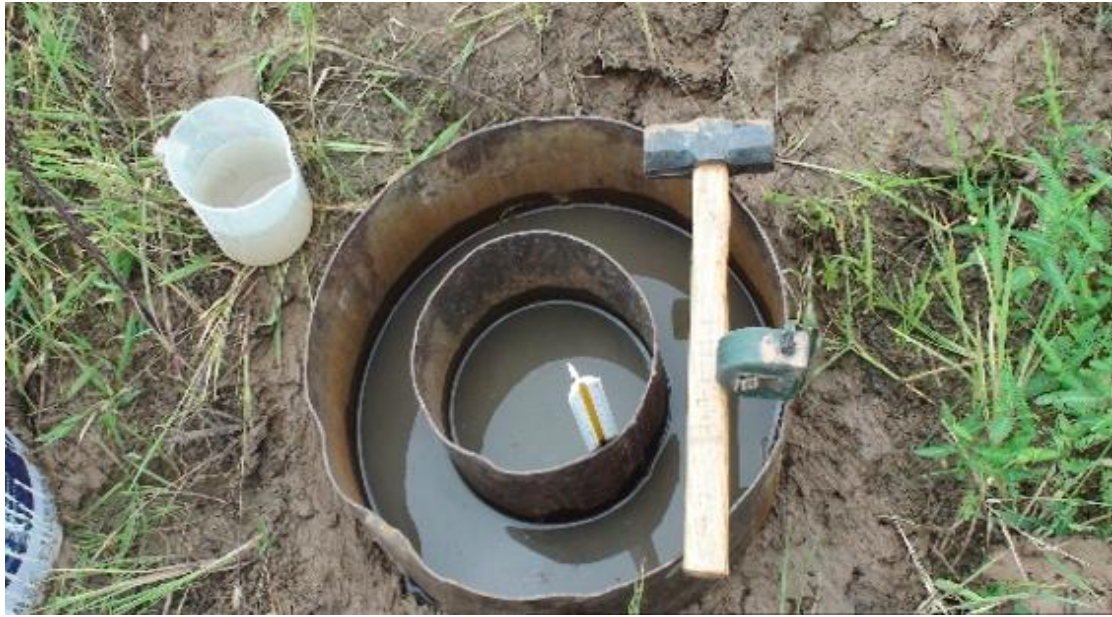
图 5.2-12 渗水试验现场照片
